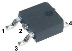
PIN1 : G      PIN 2 : D      PIN 3 : S      PIN 4 : D
